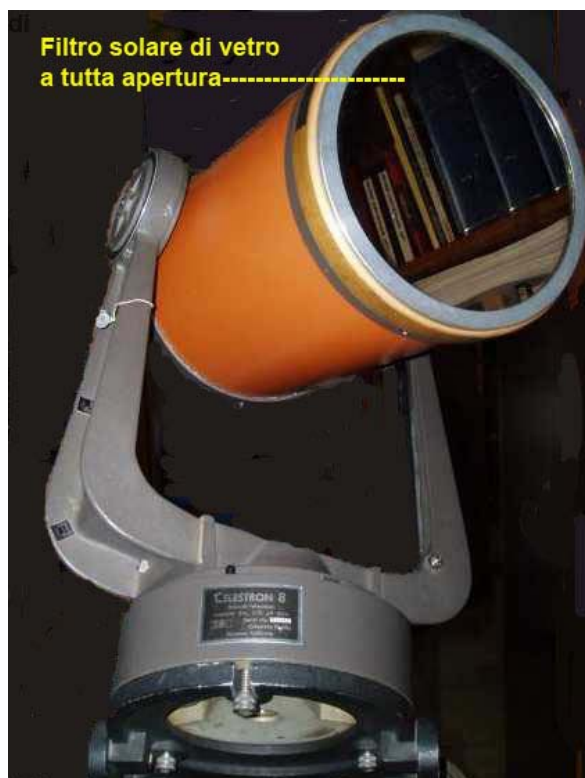
Figura 9: un telescopio dotato di filtro solare in vetro a tutta apertura.
